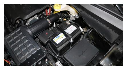
Аккумулятор находится в моторном отсеке. Его функция заключается в обеспечении двигателя электроэнергией для нормального запуска автомобиля и в поддержании оптимальной работы различного электрического оборудования в автомобиле.
