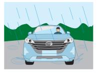
При движении в дождливую погоду переднее ветровое стекло запотевает — это происходит из-за разницы температур внутри и снаружи автомобиля. Чтобы убрать запотевание, можно включить кондиционер и направить воздух на ветровое стекло, используя функцию охлаждения. Таким образом можно быстро избавиться от запотевания.
