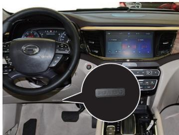
Коленная подушка безопасности переднего пассажира установлена под перчаточным ящиком и обозначена фразой SRS AIRBAG.
