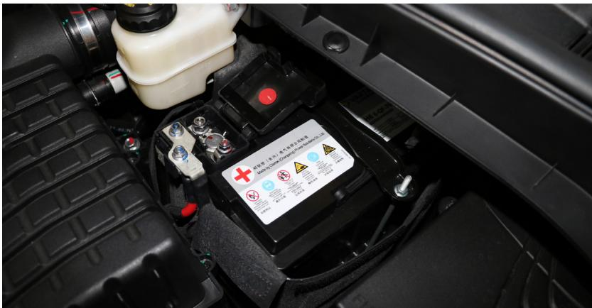
Аккумулятор находится в моторном отсеке. Его функция заключается в обеспечении двигателя электроэнергией для нормального запуска автомобиля и в поддержании оптимальной работы различного электрического оборудования в автомобиле.
